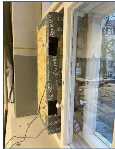
Dies lässt in der Auswertung Rückschlüsse auf die Materialeigenschaften des Bauteils hinsichtlich der bauphysikalischen Konsequenzen wie Schimmelbildung in Innenräumen zu. Die Studierenden erstellen hierzu Modelle zu verschiedenen **Außenwandaufbauten** und bauen diese, mit der entsprechenden Messtechnik versehen, in verschiedene Fensteröffnungen in der STB ein. So kann deren **Tauglichkeit** sowie die Auswirkungen bei Störungen des **Schichtaufbaus** ermittelt werden.
